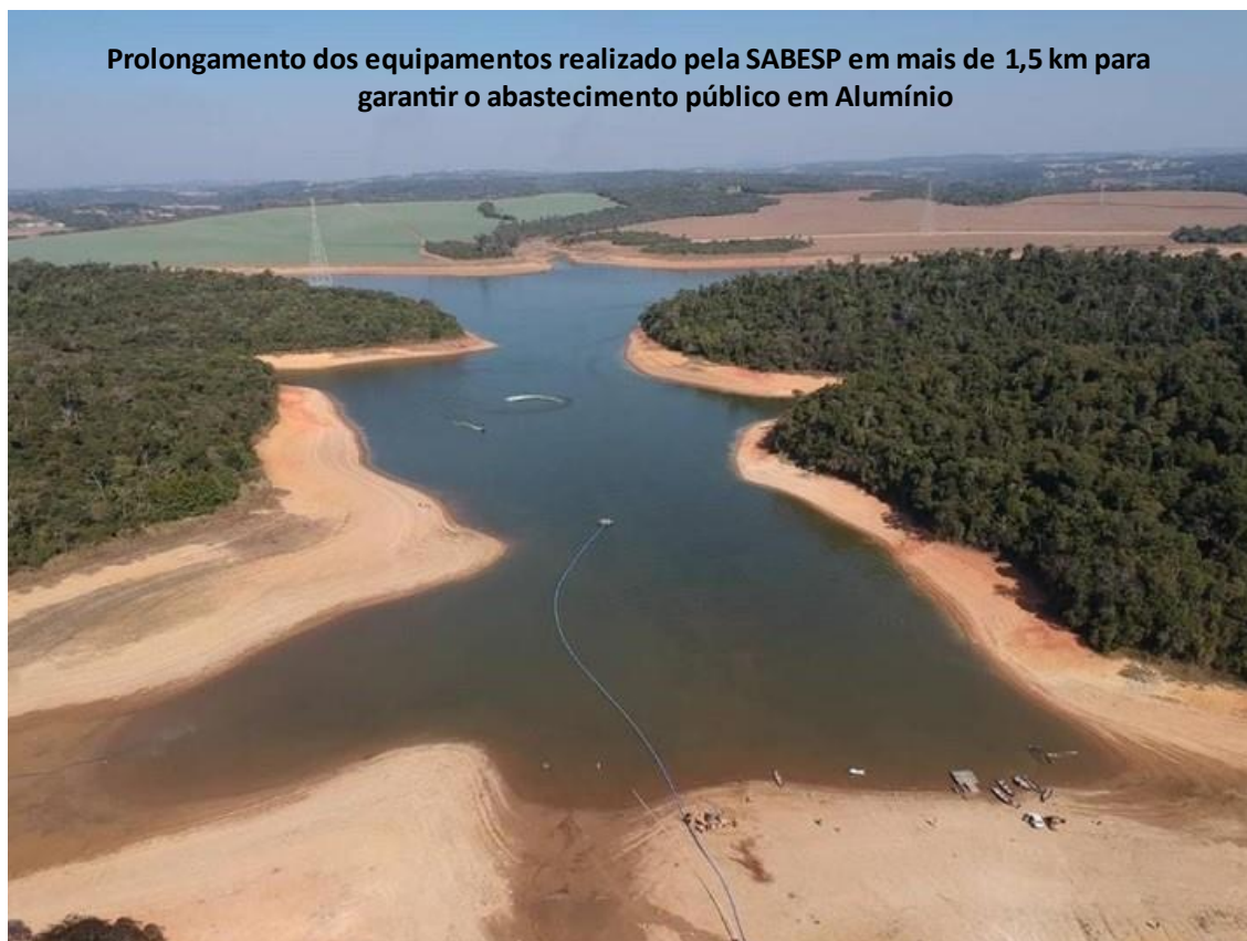
Fig. 47. Prolongamento dos equipamentos SABESP em 0,5km para dentro da represa, devido à crise hídrica, para garantir o abastecimento público em Alumínio, SP (RMS). Fonte: SABESP, 2021 apud Waldnir Gomes.
